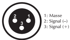
DMX-Ausgang XLR-Einbaubuchse:
